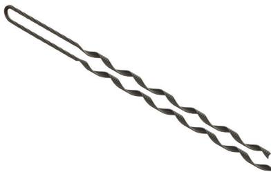
A Alça [APCO] é utilizada na ancoragem de cabos ópticos. Fabricada a partir de fios de liga de alumínio de alta resistência, recebe na parte interna um material abrasivo para melhorar a fixação sobre o cabo.
