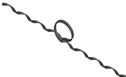
O Laço [LPFF] é utilizado na amarração do fio FEB em isolador de roldâna Ø25,4 mm. Fabricado a partir de fios de aço galvanizado, recebe na parte interna um material abrasivo para melhorar a fixação sobre o cabo.
