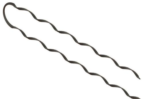
A Alça [APFF] é utilizada no encabeçamento do fio FEB em isolador de roldana Ø 25,4 mm. Fabricada em aço galvanizado, recebe na parte interna um material abrasivo para aumentar o agarramento sobre o fio.
