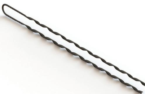
A Alça Pré-formada para Cordoalha Elétrica [APCD] destina-se à ancoragem das cordoalhas, dependendo do caso, deve ser usada juntamente com guarda-cabo ou manilha sapatinha. Fabricada a partir de fios de aço galvanizado e recebe na parte interna um material abrasivo para melhorar o agarramento sobre o cabo.
