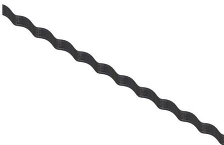
O Protetor de Linha [PPL] tem por objetivo a aplicação em cabos condutores de energia CA/CAA, onde seja necessária uma proteção mecânica sobre o cabo. Pode ser utilizada em pontos de suspensão, amarração e também pontos de reparo mecânico e elétrico nos casos em que o dano não ultrapasse 25% da quantidade de fios do cabo. Fabricada em liga de alumínio. Constituem um grupo de varetas não coladas e sem a presença de abrasivos.
