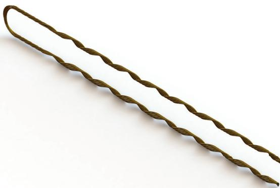
A Alça Pré-formada [APRC] para Cabo Revestido de Cobre destina-se à execução de pontos finais mecânicos em cabos de aço revestido de cobre, onde se requer grande resistência à tração sem danificar o cabo por concentração de esforços. É fabricada a partir de fios de aço revestidos de cobre e recebe na parte interna um material abrasivo para melhorar o agarramento sobre o cabo.
