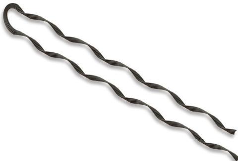
A Alça Pré-formada de Distribuição [APD] destina-se à execução de pontos finais mecânicos no primário junto ao isolador de disco, ou no secundário diretamente no isolador de roldana para cabos de alumínio CA/CAA. Fabricada a partir de fios de aço galvanizado ou aço galvanizado revestido de alumínio, o qual deve ser indicado com as letras "RA" após o código principal. Recebe na parte interna um material abrasivo para melhorar a fixação sobre o cabo.
