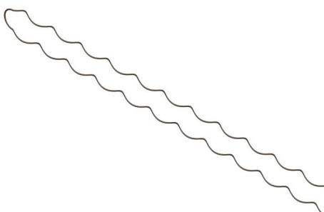
A Alça [APFE] é utilizada no encabeçamento do fio FE e FEEA, em isolador de roldana. Fabricada em arame de aço galvanizado.
