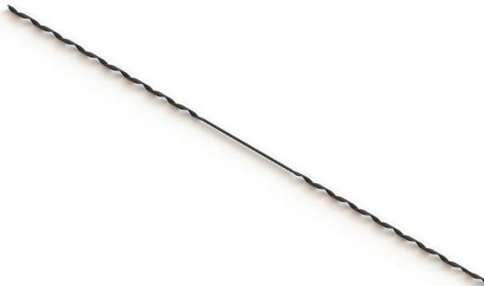
A Alça de Contra Poste ou Fixador de Estai [FPE] destina-se à fixação do cabo de aço ao poste nas aplicações onde se utiliza o próprio cabo de aço como uma alça para o poste. Utilizada em cabos EHS, HS e SM. Fabricada a partir de fios de aço galvanizado, recebe na parte interna um material abrasivo para melhorar o agarramento sobre o cabo.
