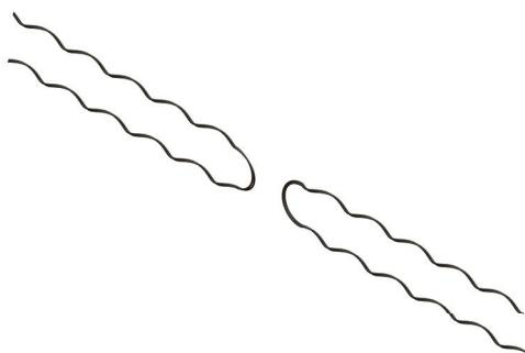
O Laço Lateral Duplo [LPLD] destina-se à amarração do condutor de aço galvanizado lateralmente no “pescoço” do isolador de pino em cruzetas duplas. Fabricado a partir de fios de aço galvanizado, recebe na parte interna um material abrasivo para melhorar o agarramento sobre o cabo. É fornecido com dois coxins de elastômero.
