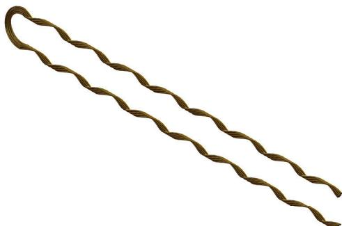
A Alça Pré-formada de Distribuição (APAC) destina-se à execução de pontos finais mecânicos no primário junto ao isolador de disco, ou no secundário diretamente no isolador de roldana para cabos de cobre. É fabricada a partir de fios de liga de cobre, ou fabricada em aço galvanizado revestido de cobre, deve receber as letras "RC" após o código principal e trocar o primeiro dígito da codificação pelo número 1. Recebe na parte interna um material abrasivo para melhorar o agarramento sobre o cabo.
