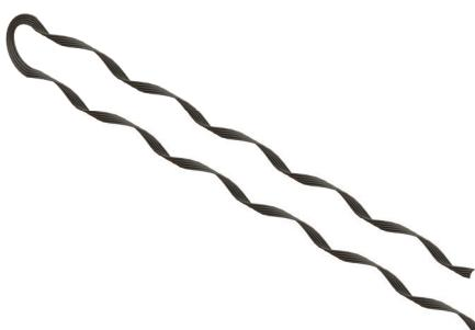
A Alça [ACCE] é utilizada para ancorar diretamente o cabo CCE-APL-ASF em postes circulares. Fabricada em aço galvanizado, recebe na parte interna um material abrasivo para melhorar a fixação sobre o cabo.
