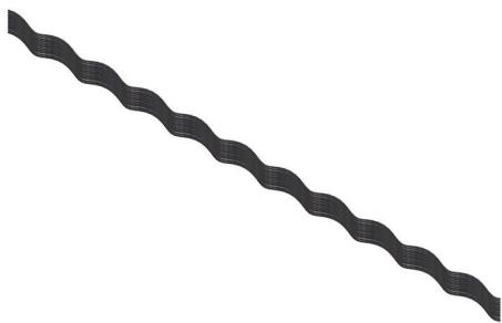
A Armadura Pré-formada [AP] é o produto que oferece proteção mecânica e elétrica nos pontos onde são utilizados grampos de suspensão ou de reparo aos cabos de aço revestido de alumínio. Fabricada em aço revestido de alumínio. Constituem um grupo de varetas não coladas e sem a presença de abrasivos.
