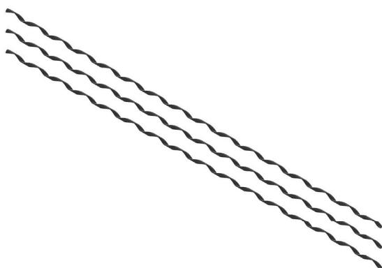
A Emenda para Cabo de Aço [EPCA] tem por finalidade emendar cabos de aço EHS, HS e SM, sendo que o sentido de hélice da emenda deve ter o mesmo sentido de acordoamento dos cabos de aço. As emendas tradicionais são "sentido anti-horário". Fabricada em aço galvanizado, recebe na parte interna um material abrasivo para melhorar o agarramento.
