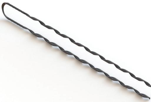
A Alça Pré-formada [APRA] para Cabo Revestido de Alumínio destina-se à execução de pontos finais mecânicos em cabos de aço revestido de alumínio, onde se requer grande resistência à tração sem danificar o cabo por concentração de esforços. É fabricada a partir de fios de aço revestidos de alumínio e recebe na parte interna um material abrasivo para melhorar o agarramento sobre o cabo.
