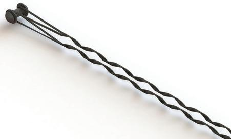
A Alça Pré-formada com Olhal [APDO] destina-se ao encabeçamento do condutor de alumínio CA/CAA no primário e em redes de eletrificação rural. Substitui a Alça Pré-formada de Distribuição, pois é aplicada diretamente no olhal do isolador de disco. Fabricada a partir de fios de aço galvanizado ou aço revestido de alumínio, recebendo as letras "RA" após o código principal para esta condição de fabricação. Recebe na parte interna um material abrasivo para melhorar o agarramento sobre o cabo.
