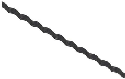
A Armadura Pré-formada [AP] oferece proteção mecânica e elétrica nos pontos onde são utilizados grampos de suspensão ou de reparo aos cabos CA/CAA. Fabricada em alumínio. Constituem um grupo de varetas não coladas e sem a presença de abrasivos.
