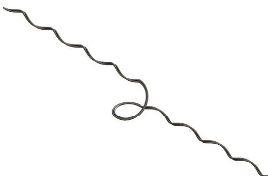
O Laço Pré-formado de Distribuição [LPT/C,F,K] destina-se à amarração do condutor de aço galvanizado no topo do isolador de pino, protegendo o condutor contra a fadiga causada pela vibração do cabo. Fabricado a partir de fios de aço galvanizado, recebe na parte interna um material abrasivo para melhorar o agarramento. Fornecido juntamente um coxim de elastômero que deve ser aplicado sobre o condutor.
