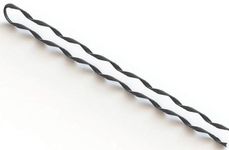
A Alça Pré-formada de Distribuição [APDA] destina-se à execução de pontos finais mecânicos no primário junto ao isolador de disco, ou no secundário diretamente no isolador de roldana para cabos de alumínio. É fabricada a partir de fios de alumínio de alta resistência. Recebe na parte interna um material abrasivo para aumentar o agarramento sobre o cabo.
