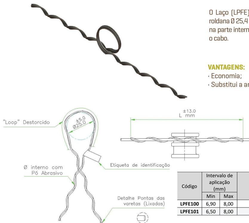
O Laço [LPFE] é utilizado na amarração do fio FE em isolador de roldana Ø 25,4 mm. Fabrica a partir de fios de aço galvanizado, recebe na parte interna um material abrasivo para melhorar a fixação sobre o cabo.
