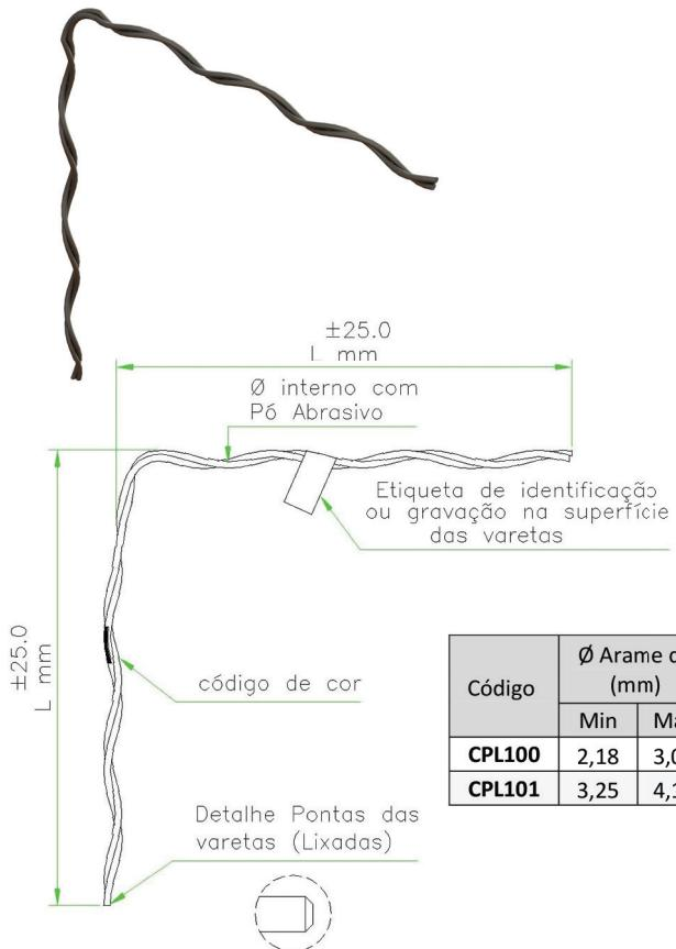
O Conector Pré-formado "L" [CPL] é indicado para fazer a conexão para o aterramento de cercas de arame farpado ou liso. Fabricado em fios de arame de aço galvanizado, recebem em sua parte interior um material abrasivo para melhorar o agarramento.
