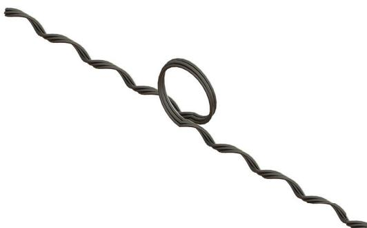
O Laço de Roldana [LPR] destina-se à fixação do condutor de aço galvanizado em isoladores de roldana. Fabricado em aço galvanizado, recebe na parte interna um material abrasivo para melhorar o agarramento. É fornecido com coxim de elastômero, que deve ser aplicado sobre o condutor, a fim de evitar o contato deste com a roldana.
