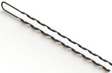
A Alça Pré-formada para Cabo de Aço [APE] destina-se à ancoragem de cabos de aço galvanizado. Dependendo do caso deve ser usada juntamente com guarda-cabo ou manilha sapatilha. É fabricada a partir de fios de aço galvanizado e recebe na parte interna um material abrasivo para melhorar o agarramento sobre o cabo.
