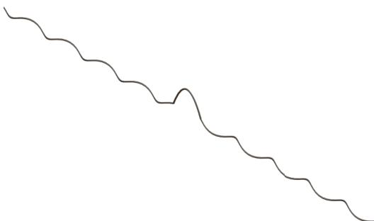
O Laço Metálico [LPM] é utilizado na fixação do mensageiro de aço galvanizado em isoladores de rede compacta. Fabricado em aço galvanizado, recebe na parte interna um material abrasivo para melhorar o agarramento.
