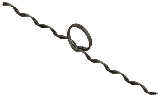
O Laço Lateral [LPL/C,F,K] destina-se à fixação do cabo ou fio de aço galvanizado no “pescoço” do isolador de pino. Fabricado em fios de aço galvanizado, recebe na parte interna um material abrasivo para melhorar o agarramento sobre o cabo. É fornecido juntamente o coxim de elastômero, que deve ser aplicado sobre o condutor.
